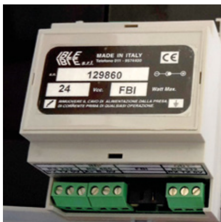
FBI / EXT Interfaccia remota per connessione sistemi carburanti. Remote interface for connective fuel system
